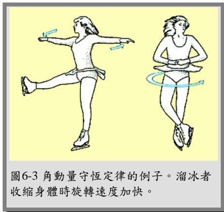
圖6-3 角動量守恆定律的例子。溜冰者收縮身體時旋轉速度加快。
